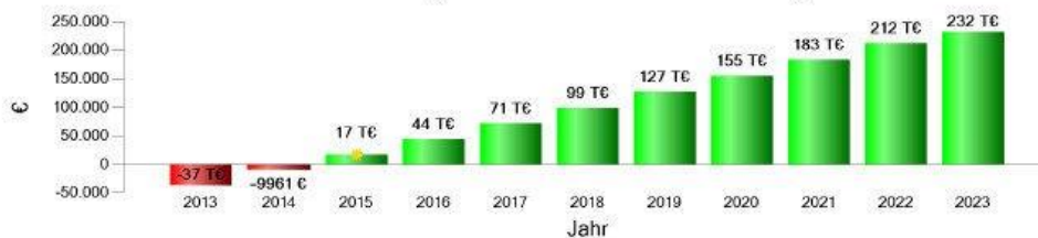
Amortisation (mit BHKW / ohne neuen Kessel)
