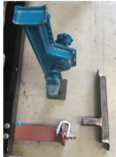
Abbildung 52 - Stockwinde und Aufstellhilfe
