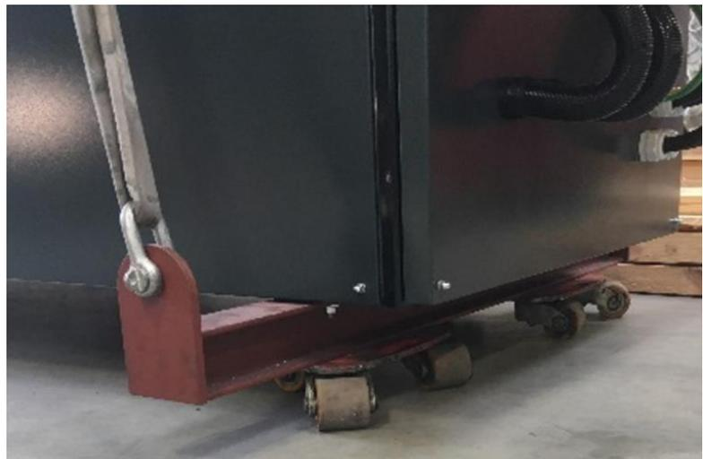
Abbildung 51 - BHKW auf Transporttraversen und Schwerlastrollen (rechts)
