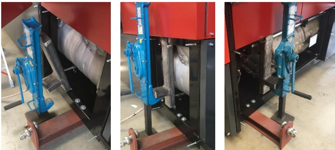
Abbildung 53 - Handhabung der Stockwinden und Aufstellhilfen
