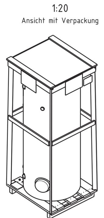
Trinkwassererwärmer gemäß EN 12897
