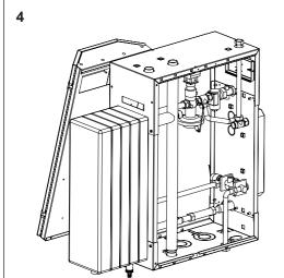
**Schritt 4:** Drehen Sie den Schaltschrank auf die gegenüberliegende Seite des Grundgehäuses.
