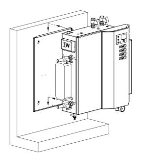
Nachdem die Montageposition in Höhe und seitlicher Ausrichtung festgelegt wurde, kann nun das erste Loch der Grundplatte markiert werden. Dieses liegt immer auf der Netzanschlussseite, jeweils 75 mm von Ober- und Seitenkante des Gehäuses entfernt. Die Markierung der weiteren Befestigungspunkte wird mittels der lotrecht angehaltenen Grundplatte oder durch Anzeichnen eines Rasters von waagerecht 400mm und senkrecht 625mm vorgenommen.
