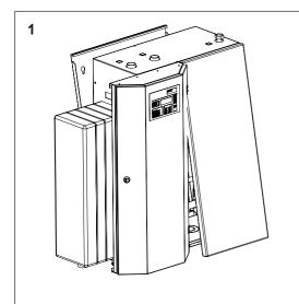
**Schritt 1:** Entfernen Sie die vordere Abdeckhaube sowie die hintere Grundplatte durch leichtes Hoch- bzw. Herunterdrücken der Oberkanten.
