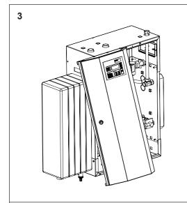
**Schritt 3:** Hängen Sie den Schaltschrank durch kräftiges Ziehen an der unteren Federbolzenhalterung aus.
