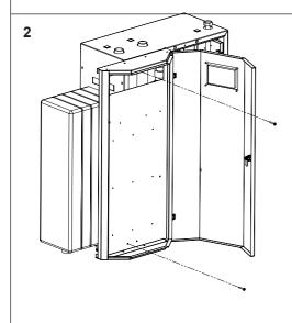
**Schritt 2:** Öffnen Sie den Schaltschrank wie dargestellt und lösen Sie die beiden Sicherheitsschrauben. Verschließen Sie den Schaltschrank anschließend wieder.
