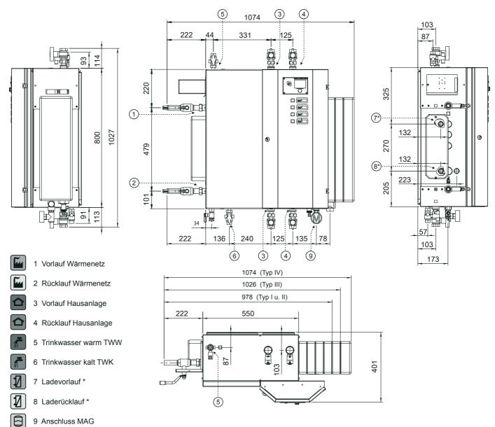
\*7/\*8) Bei direktem Anschluss am Wärmenetz (Speichersystem Typ DS) befinden sich anstelle des Wärmeübertragers TWE die Anschlüsse des Registerspeichers.
